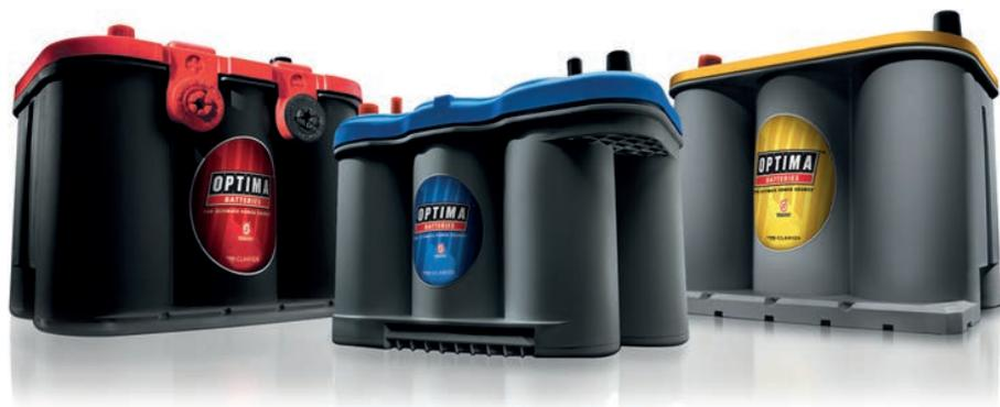
La batería **OPTIMA** está basada en la **Tecnología SpiralCell®**. En lugar de las placas planas usadas en las baterías convencionales, utiliza dos placas de plomo estrechamente enrolladas en una espiral entre las que se encuentra la microfibra de vidrio que contiene el ácido. La técnica de enrollar las placas, unidas por sólidas conexiones, ofrece las máximas prestaciones con el mínimo peso y tamaño.
